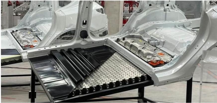
**Figura 35:** Batería estructural conformada por elementos cilíndricos.
