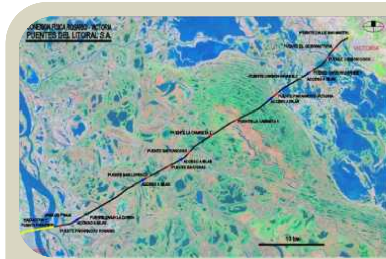
Conexión Vial Rosario Victoria. En rojo se marcan los puentes aliviadores y en azul los accesos a las islas. Fuente: Puentes del Litoral S.A.
